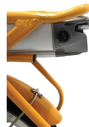
Obrázek 8: Zapojte konektor, zatlačte baterii na konektor.
