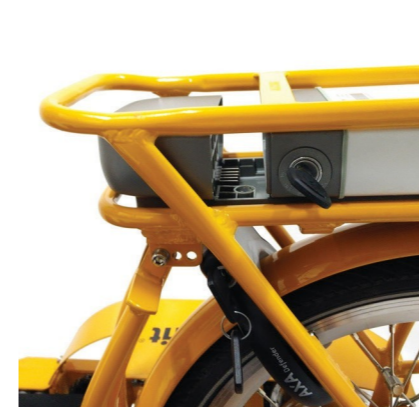
Obrázek 7: Stisknutím a otočením klíčku proti směru hodinových ručiček vyjměte baterii.
