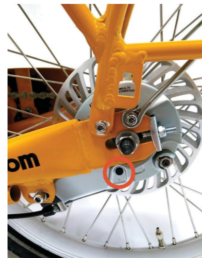
Obrázek 17: Odstraňte krytku brzdy a doplňte mazivo.
